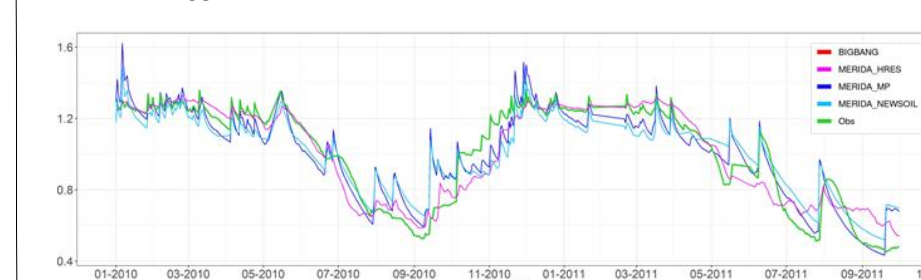
Figura 2.5 Umidità del suolo normalizzata rispetto al valore medio per ciascuna configurazione modellistica (MERIDA_HRES, MERIDA_MP, MERIDA_NEWSOIL), BIGBANG e l'osservato nella stazione di misura Water-Engineering-Experimental-Field 1 per la profondità 0.25 m.
